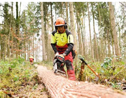
Mit dem Streifenmesseraufsatz für Motorsägen geschlitzte Fichtenstämme. In dem stark fragmentierten Bast haben Buchdrucker nahezu keine Chancen mehr sich fortzupflanzen. Foto: Tobias Hase (StMELF)
