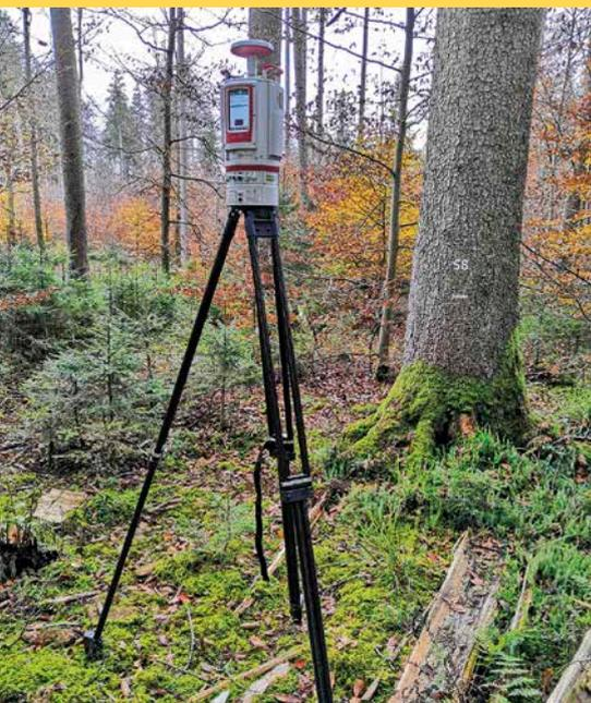
1 Mit Hilfe eines Laserscanners wurden die dreidimensionalen Kronenstrukturen erfasst und verschiedene Kronenparameter berechnet. Foto: Luke Bohnhorst
