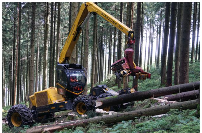
Abb. 7: Spezielle Hangharvester bewältigen auch Steigungen von über 50%.
