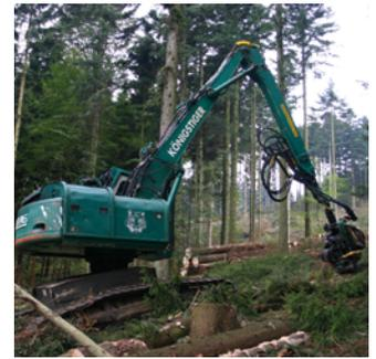
Abb. 5 (links): Traktionsbänder erweitern die Einsatzgrenzen am Hang nur bedingt. Abb. 6 (rechts): Baggerharvester
