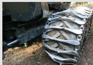
Abb. 9: (links) Traktionsband mit hohen und schmalen Stegen für den Einsatz in steilem Gelände.
