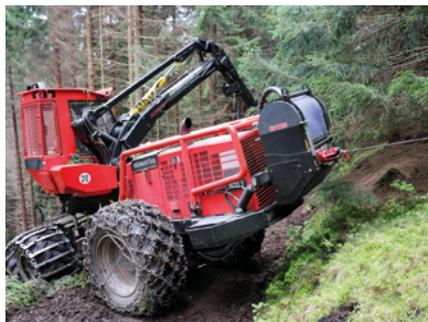
Abb. 11: Traktionshilfswinde an einem Radharvester
