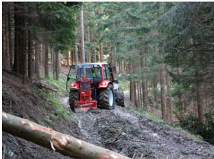
Abb. 3: Rücken mit der Seilwinde
