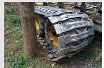
Abb. 10: (rechts) Plattenartige Bänder für Weichböden bieten mehr Auflagefläche, verbessern aber nicht die Traktion.
