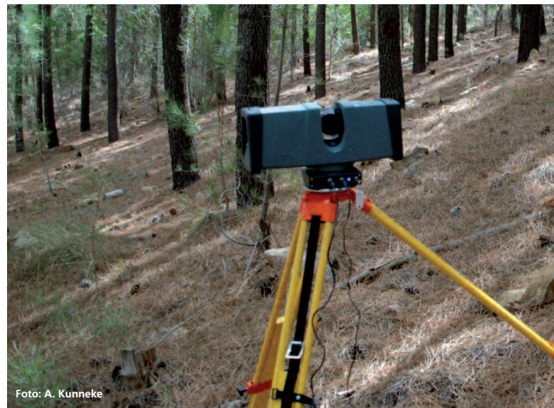
Abbildung 1: Laserscanner in einer südafrikanischen Pinus radiata -Plantage. Der Laserscanner selbst gibt nur ein wenig spektakuläres Bild ab, die Bilder jedoch, die er von Waldbeständen aufzeichnet, können zu weitreichenden Veränderungen in der »Landschaft« forstlicher Inventuren führen.
