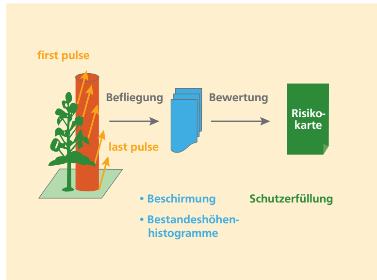
Abbildung 4: Schematischer Ablauf einer Laserscanner-Auswertung von Schutzwaldbeständen
