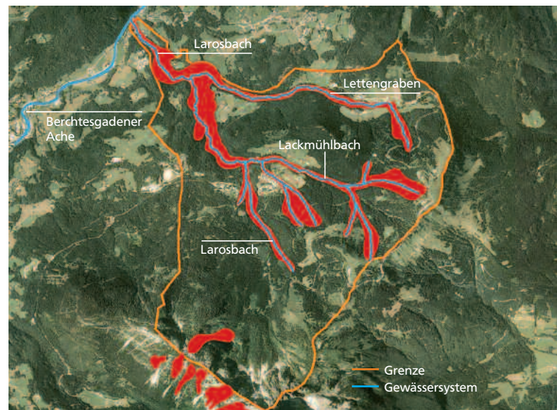
Abbildung 1: Das Testgebiet »Larosbach« im Luftbild; die roten Flächen zeigen die unmittelbar mit dem Gewässersystem verbundenen Erosionsbereiche.
