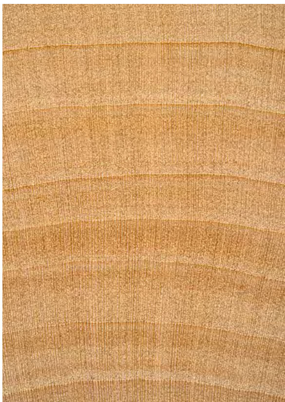
Abbildung 3: Linde, Querschnitt. Lupenbild im Maßstab 7:1. Gefäße in zerstreutporiger Anordnung, fein und sehr zahlreich; Holzstrahlen unauffällig; Jahrringgrenzen wenig ausgeprägt Foto: Holzforschung München
