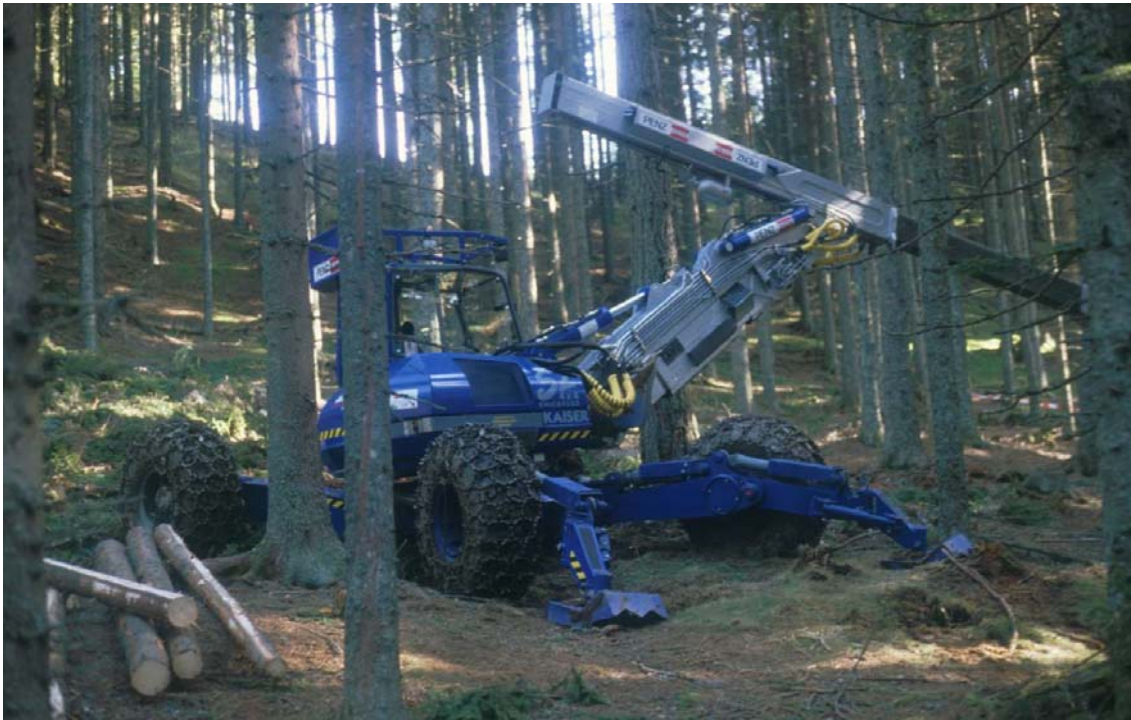
Abb. 7: Harvester auf Basis eines „Kaiser“- Schreitbaggers (Photo: LWF)
