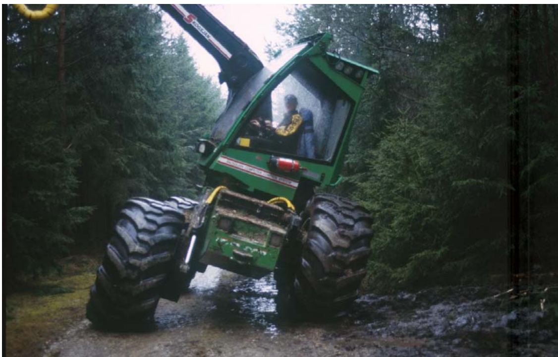
Abb. 3: Radharvester mit niveauregulierbarem Fahrwerk (Photo: LWF)
