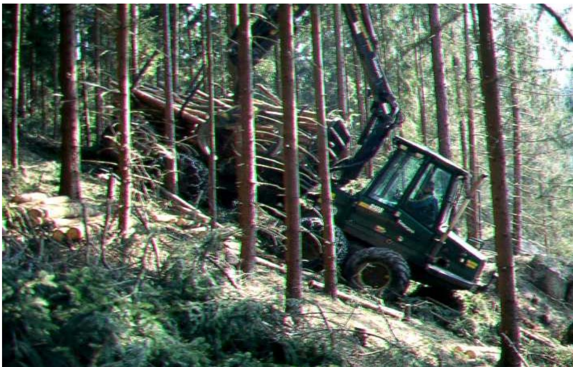
Abb. 13: Rad-Forwarder Timberjack 810 im Einsatz am Hang (Photo: LWF)
