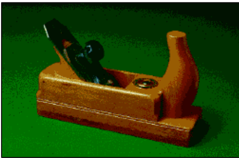
Abb. 12: Lange Zeit gehörte Birnbaum zu den wichtigsten Holzarten für Werkzeuge. Für Spezialwerkzeuge, wie Putzhobel, konnte er sich bis heute behaupten [Foto: D. Grosser].
