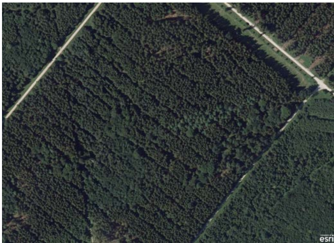
Luftbild eines gleichmäßigen Rückegassensystems zwischen Lkw-befahrbar Forstwegen.
