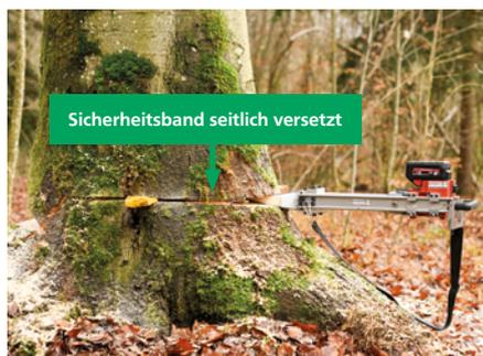
Abb. 1: Mechanischer Fällkeil im Schnabelschnitt.
