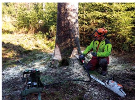
Abb. 2: Fernbedienbarer hydraulischer Fällkeil.
