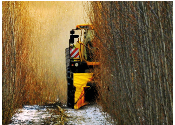
Die Ernte mit einem Gehölmähähcksler ist aktuell die günstigste und auch ergonomisch die geeignetste Variante.
