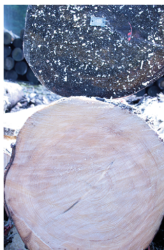
Gute Qualitäten aus dem Nasslager. Bei sachgerechter Lagerung und Beregnung liefern Nasslagerplätze hochwertige Ware: Weiße Stirnflächen nach Anschnitt, oben Verfärbung durch Beregnung und Bewuchs.
