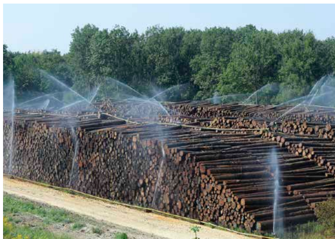
Beregnungspolter auf einem professionell betriebenen Nasslagerplatz.
