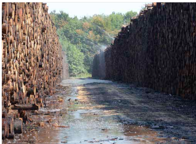
Der Aufbau eines Nasslagers bedarf umsichtiger Planung und Durchführung, um etwa unerwünschte Vernässungen und Trockenfallen von Stirnflächen zu vermeiden.
