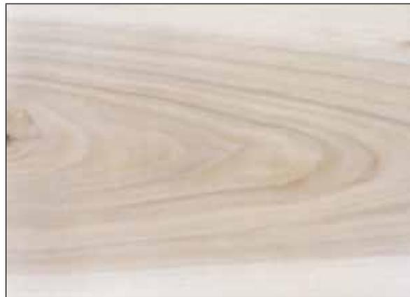
Abb. 2: Holz der Schwarzpappel mit nur noch schwach getöntem Kernholz nach der Austrocknung (Foto: R. Rosin / D. Grosser)
