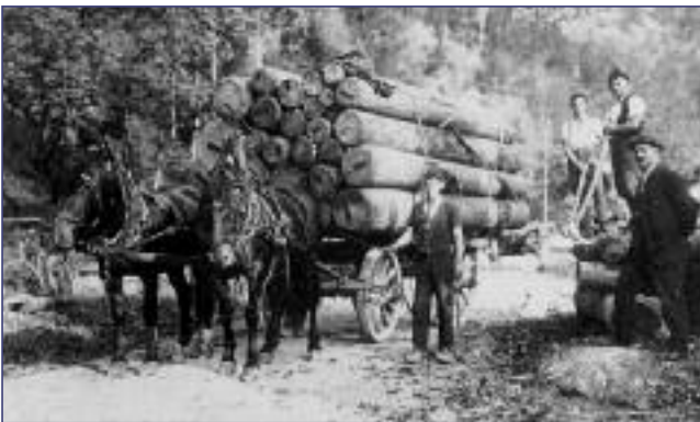
Schmalspurige Räder mit Metallreifen übten einen sehr hohen Druck auf die Bodenoberfläche aus, es kam zu Geleisbildung. Dabei wurde der Boden durch die Hufe der Zugtiere aufgewühlt (Foto von 1926 bei Rosenheim).
