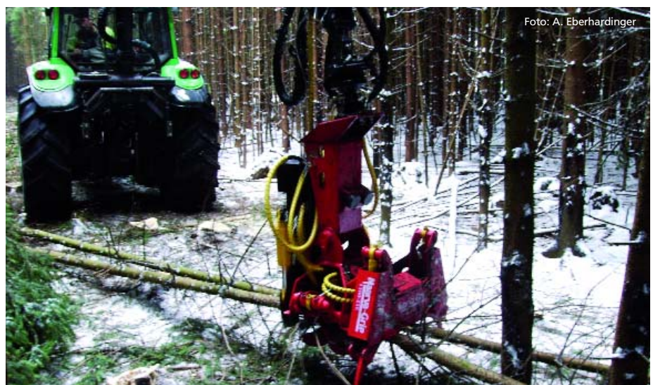
Abkürzen der Vollbäume mit dem Fällaggregat
