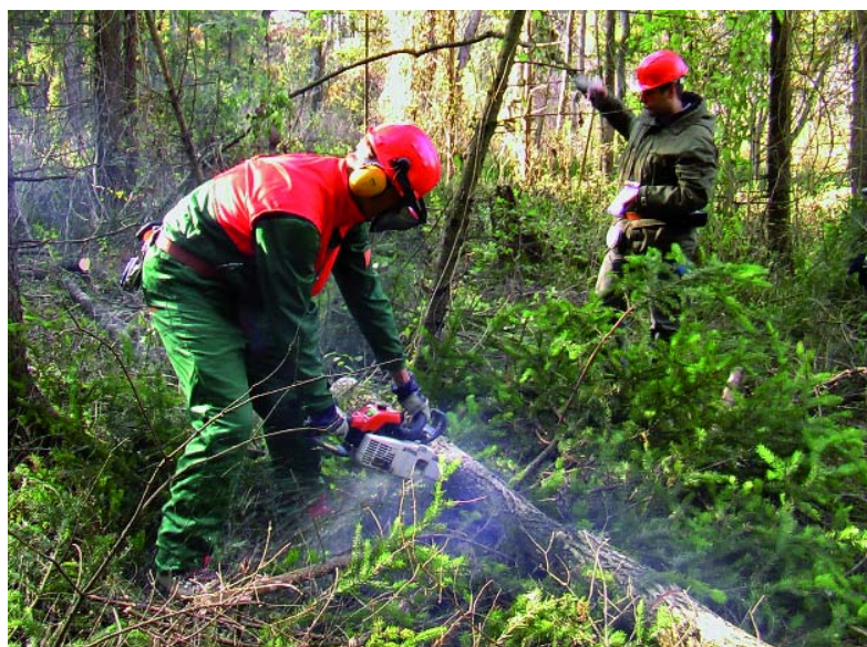
Abbildung 1: Fichten-Brennholzernte: Geübte und trainierte Waldarbeiter erreichten während der Zeitstudien die doppelte bis dreifache Leistung gegenüber ungeübten Versuchspersonen. (Foto: A. Höl-drich)
