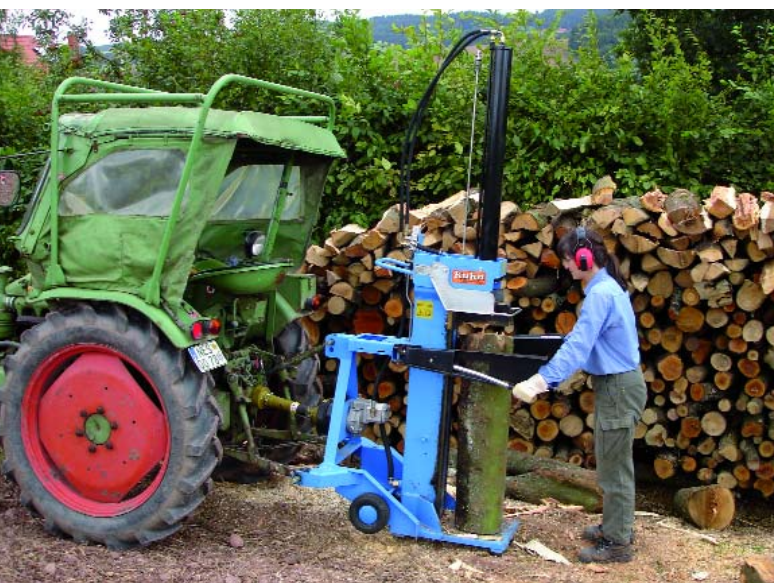
Abbildung 1: Der zapfwellengetriebene Senkrechtspalter eignet sich für einen leichten Schlepper und weist auf einen eher geringen Mechanisierungsgrad hin. (Foto: J. Hahn)
