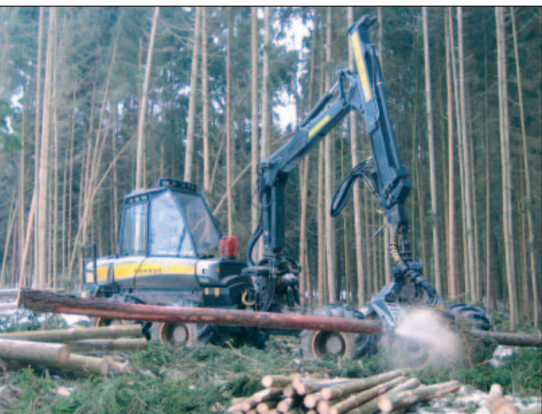
Abb. 1: Ponsse Wisent DUAL: Für eine kostenbewusste Einsatzplanung sollte die Kombimaschine vor allem als Harvester eingesetzt werden. Ein Harvesteranteil von 60-70 % wäre kostenoptimal. (Foto: A. Eberhardinger)
