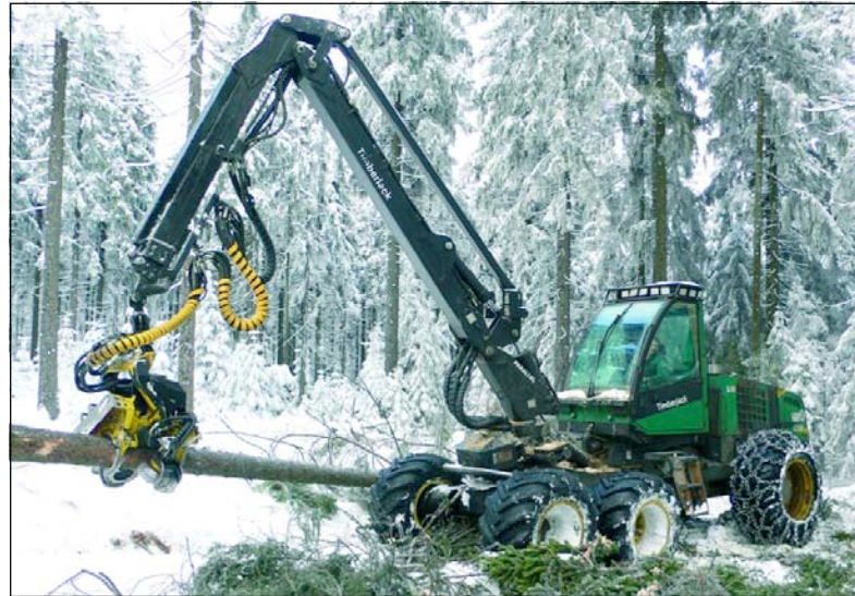
Abb. 2: Harvester müssen eine Mindestreichweite des Auslegers von 9,5 m aufweisen; Radharvester Timberjack 1270. (Foto: Forsttechnik BaySF)
