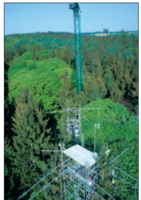
Abb. 2: Auf der Versuchsfläche der TU München im Kranzberger Forst steht ein großes Gerüst mit Kran, das den Forschern erlaubt, sich im und über dem Kronendach des Versuchsbestandes zu bewegen. (Foto: Archiv TU München)
