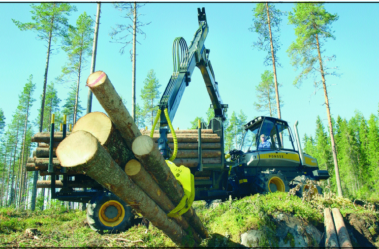
Abb. 3: 8-Rad-Rückezug Ponsse Buffalo (Foto: Fa. Gebr. Konrad GmbH, Krottendorf/A)
