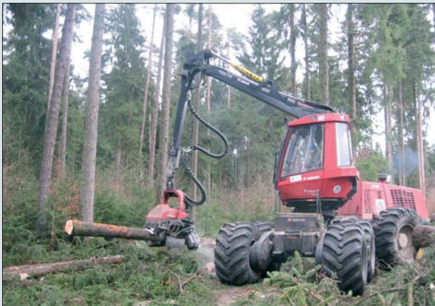
Harvester erntet im „Königsbronner Verfahren“ starkes Nadelholz. (Foto: R. Pausch)
