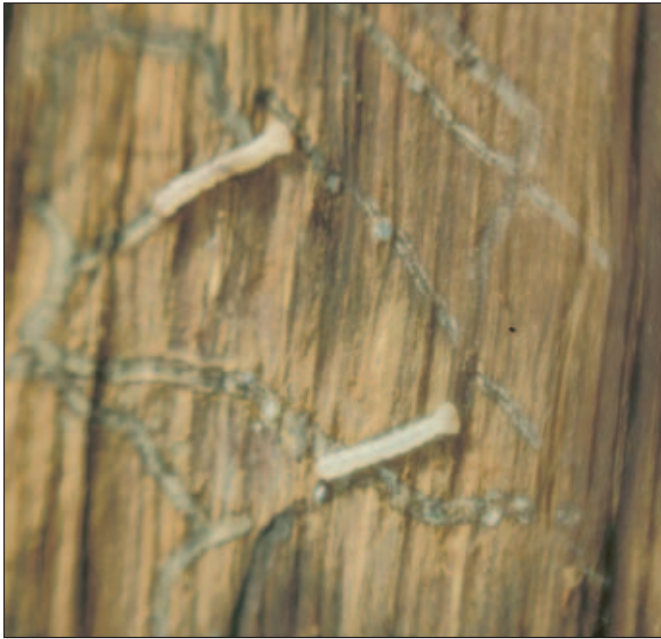
Abb. 2: Die Fraßgänge der Larven des Zweifleckigen Eichenprachtkäfers zeichnen sich teils auch im Splintholz ab und sind mit hellem Bohrmehl gefüllt. (Foto: G. Lobinger)
