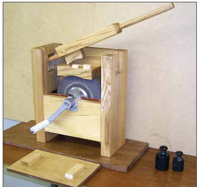
Abb. 1: Mit Holzschliff konnte Papier wesentlich günstiger hergestellt werden. Ein historischer Holzschleifer wurde an der Universität Münster nachgebaut. (Foto: WWU)
