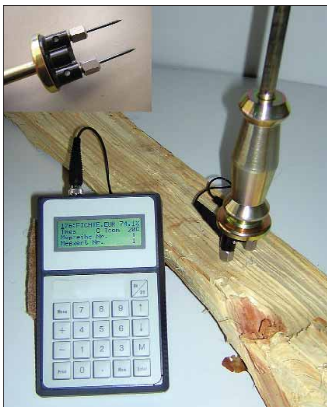
Abb. 1: Elektroden eines Holzfeuchtemessgerätes (kleines Bild) und Holzfeuchtemessgerät im Gebrauch (Foto: M. Schardt)
