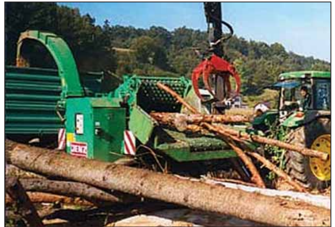
Abb. 2: Mobilhacker mit Kranbeschickung; die WBV stellt für ihre Mitglieder die notwendige Technik zur Verfügung (Foto: M. Wolf).
