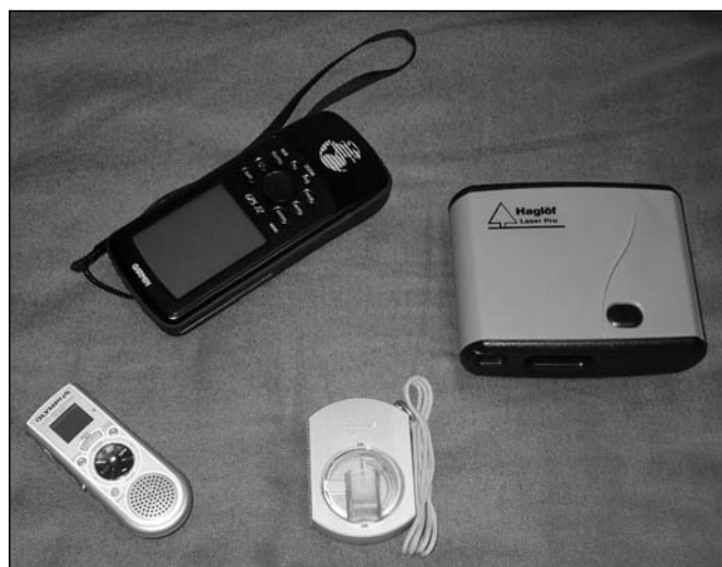
Abb. 1: Mit Laserentfernungsmesser, Kompass/Neigungsmesser, Diktiergerät und GPS-Empfänger (im Uhrzeigersinn) wurden die Daten erfasst. (Foto: G. WAAS)
