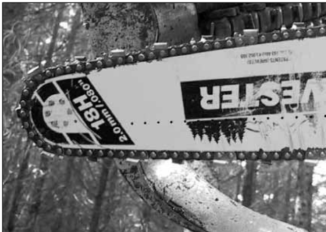
Abb. 3: Durch die Löcher im Schwert des Havestersägekopfes werden die in Wasser aufgelösten Pilzsporen während des Sägevorganges auf dem frischen Stock flächig ausgebracht. (Foto: Thumm)
