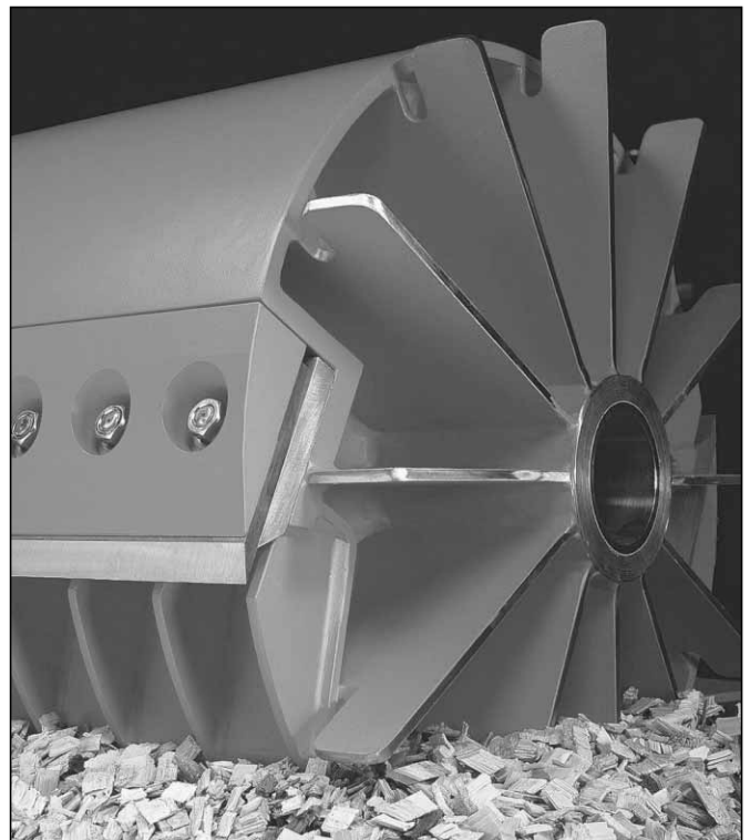
Abb. 1: Geschlossene Trommel mit durchgehenden Messern
