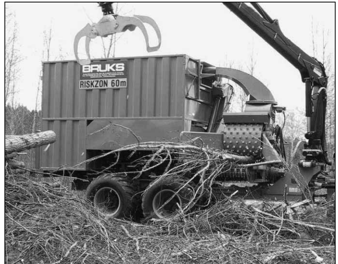
Abb. 3: Mobilhacker mit Schnitzelbunker auf Rückezug
