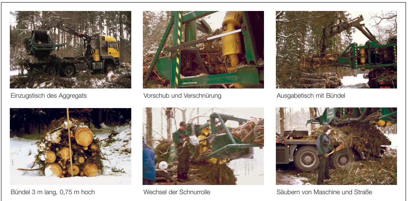
Abb. 2: Produktionsabschnitte beim Bündeln
