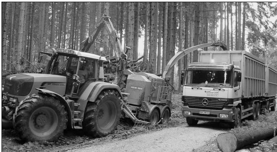
Abb. 2: Hacken direkt in aufgesattelte Container - die bevorzugte Logistikvariante des Heizkraftwerks Pfaffenhofen, Foto: Frank Günsche
