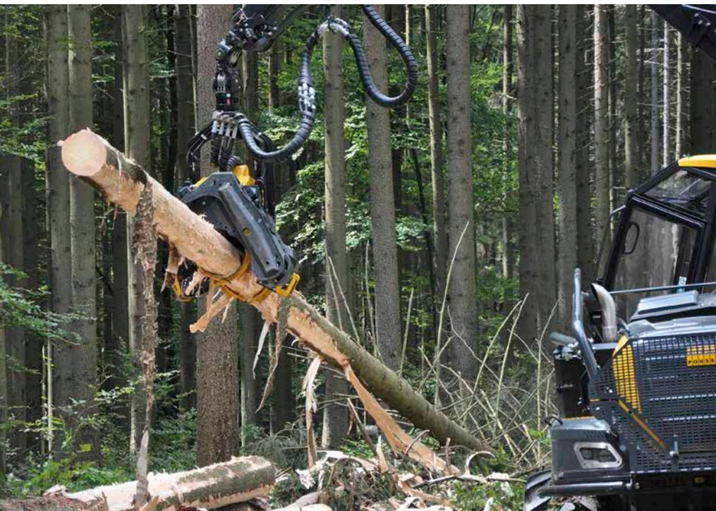
**1** Ungerüstetes Ponsse H7-Aggregat beim Entrinden einer Fichte in einem der Sommerversuche
