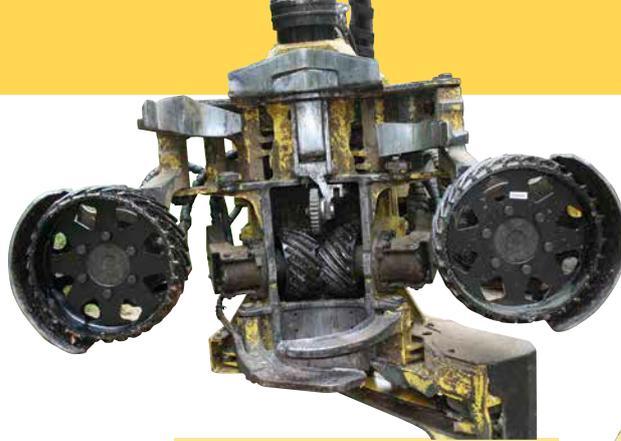
**3 Harvesterköpfe (v.l.n.r.) Log Max 7000C, John Deere H480C und Ponsse H7 nach der Modifikation zum Debarking Head entsprechend der Abbildung 2**
