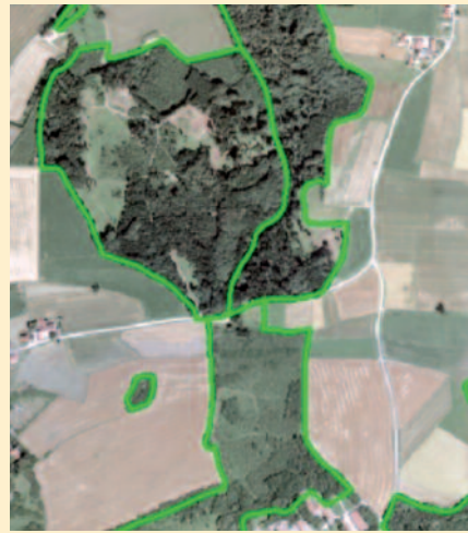
Abbildung 4: Waldrandextraktion im Testgebiet Freising mit TerraSAR-X-Daten
