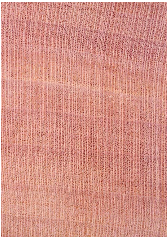
Abbildung 7: Elsbeere, Querschnitt; Lupenbild im Maßstab ~ 10:1 (Foto: R. Rosin und D. Grosser)
