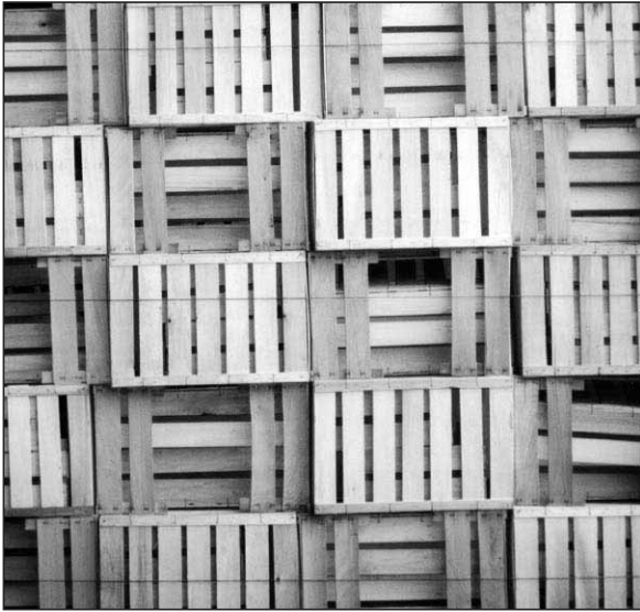
Abb. 5: Für den Transport vorbereitete Obst- und Gemüsesteigen aus Pappelholz (Foto: D. Grosser)
