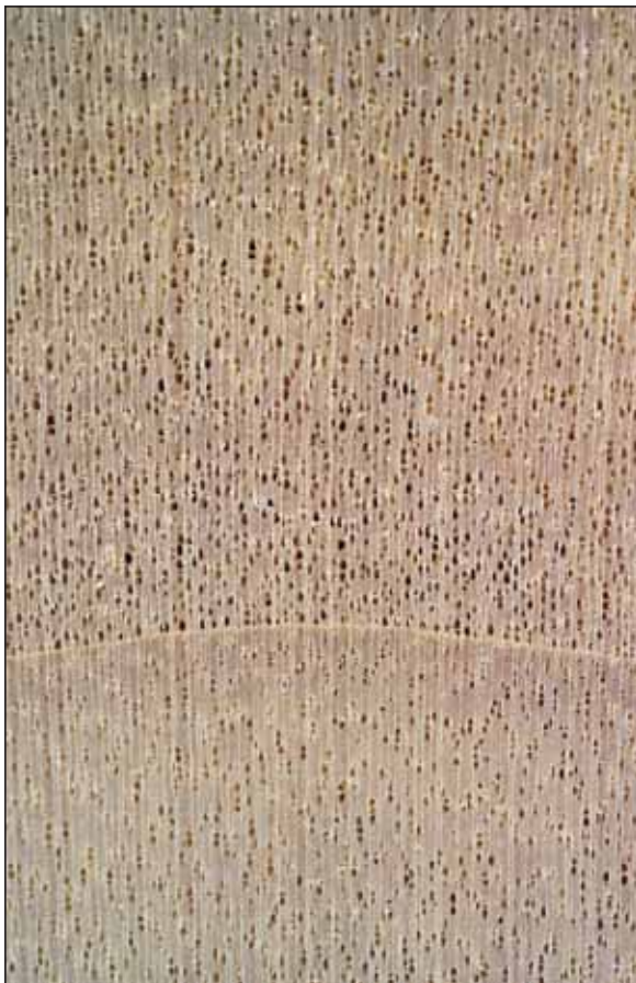
Abb. 3: Querschnitt durch das Holz einer Pappel; Lupenbild im Maßstab 6,5:1 (Foto: R. Rosin / D. Grosser)
