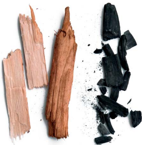
Abbildung 2: Auch aus Hackschnitzeln minderer Qualität kann Pyrolyse-Biokohle hergestellt werden, die in landwirtschaftlichen Nutzflächen oder in Gartenerde zur Bodenverbesserung eingearbeitet werden kann. Foto: T. Huber
