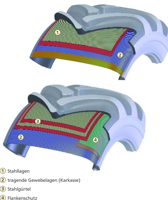
Abbildung 1: Reifenkonstruktionen für den Forst: Diagonalbauweise oben, Radialbauweise unten Grafik: Nokian
