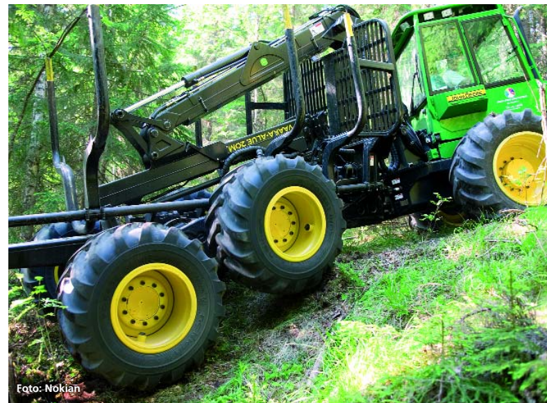
Abbildung 3: Bogieachsaggregat im Forsteinsatz; zwischen den Rädern verbleibt nur wenig Platz.
