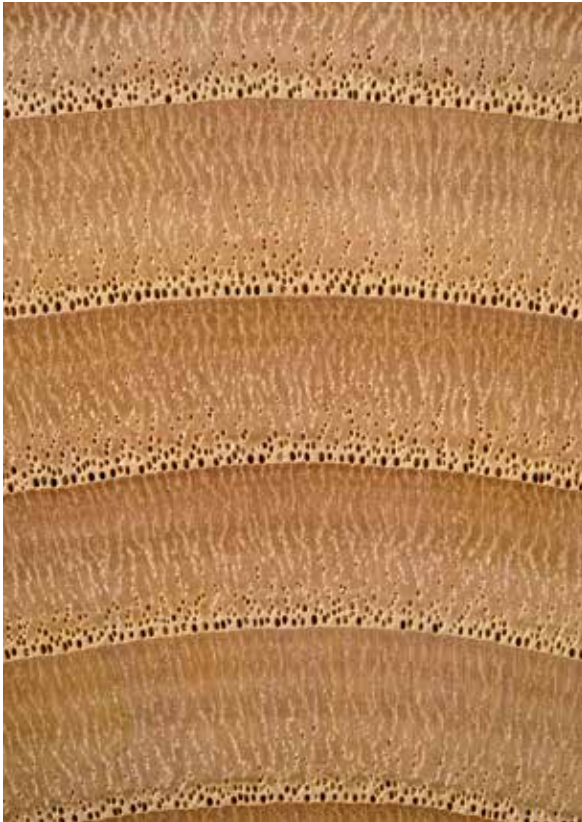
Abbildung 1A (oben links): Querschnitt Esskastanie mit deutlich abgesetzten Jahrringgrenzen und groben Frühholzporen im Ring angeordnet; feine Flammung der Spätholzgefäße und kaum erkennbare Holzstrahlen;
