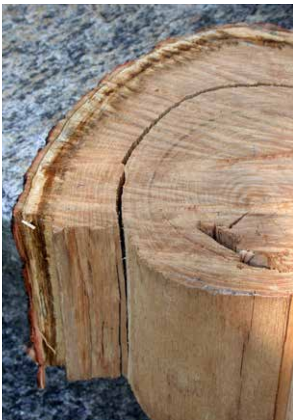
Abbildung 4: Querschnitt einer Edelkastanie mit ausgeprägter Ringschäle. Foto: P. Fonti, WSL (CH)
