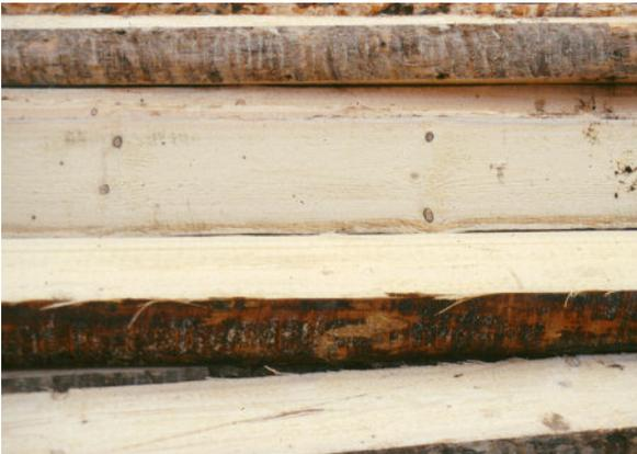
Abbildung 8: Geschnittene Bohlen aus entrindetem Holz Foto: A. Wauer
