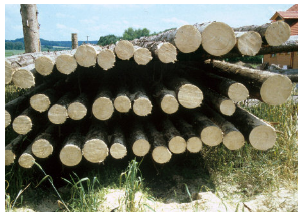
Abbildung 12: Holzqualität der Versuchspolter in der Nähe von München nach viermonatiger Lagerdauer, frische Querschnitte. Foto: Institut für Holzforschung
