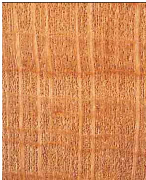
Abb. 1: Querschnitt durch Erlenholz; Gefäße fein, gleichmäßig über die Jahrringe verteilt, Holzstrahlen in typischer Bündelung zu Scheinholzstrahlen deutlich abgegrenzt; Jahrringgrenzen durch ein dichtes Spätholzband markiert; Lupenbild – 10x
