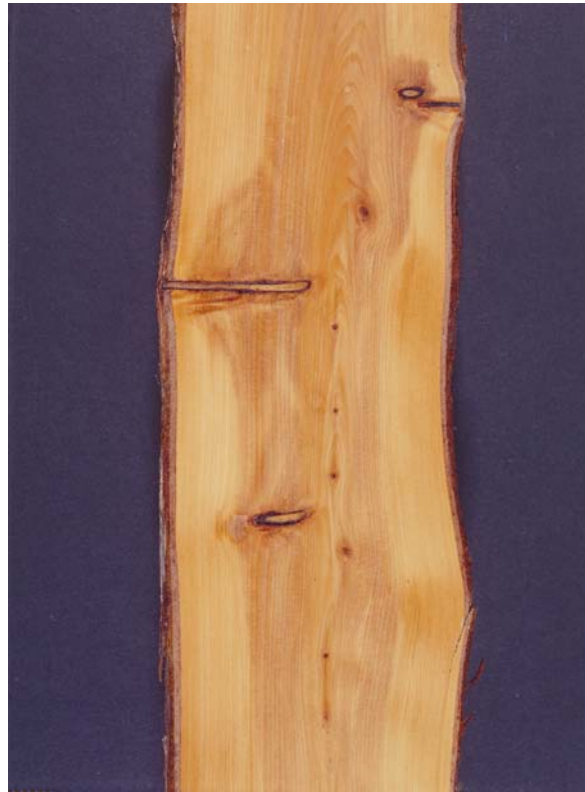
Abb. 2: Aufgetrenntes Wacholderstämmchen mit relativ breitem Splintholz und farblich abgesetztem Kernholz; Durchmesser 65 mm, Anzahl der Jahrringe ca. 40
