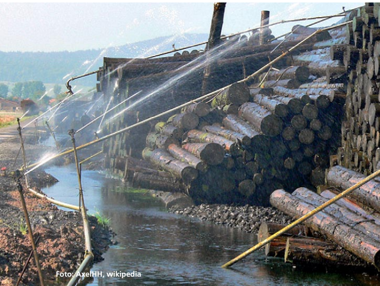
Abbildung 4: Korrektur eingerichtete Beregnungsanlagen schützen sehr zuverlässig über mehrere Jahre hinweg eingelagertes Holz vor Entwertung.
