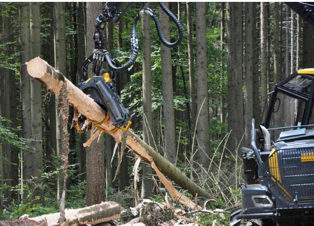
1 Ungerüstetes Ponsse H7-Aggregat beim Entrinden einer Fichte in einem der Sommerversuche Foto: J. B. Heppelmann
