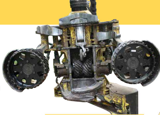
3 Harvesterköpfe (v.l.n.r.) Log Max 7000C, John Deere H480C und Ponsse H7 nach der Modifikation zum Debarking Head entsprechend der Abbildung 2 Fotos: J. B. Heppelmann und J. Grünberger
