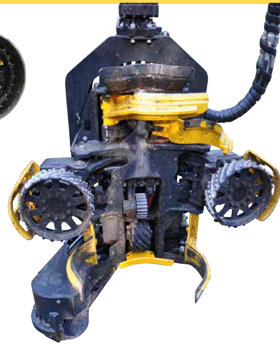
3 Harvesterköpfe (v.l.n.r.) Log Max 7000C, John Deere H480C und Ponsse H7 nach der Modifikation zum Debarking Head entsprechend der Abbildung 2 Fotos: J. B. Heppelmann und J. Grünberger
