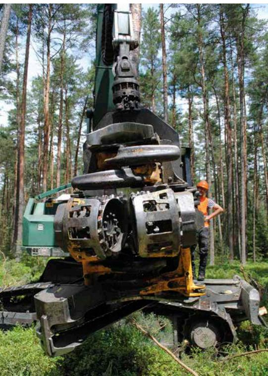
Die Kranreichweite der eingesetzten Maschine beträgt 14,5m, wodurch manuelles Beifällen nicht notwendig war und die Maßnahme vollmechanisiert durchgeführt werden konnte. Ausgehalten wurden die in Abbildung 3 aufgeführten für Kiefer üblichen Sortimente.
