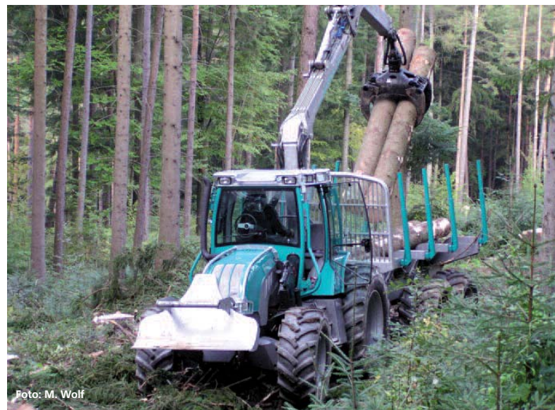
Abbildung 4: Systemschlepper der Firma Pfanzelt mit allradgetriebenem Rückeanhänger
