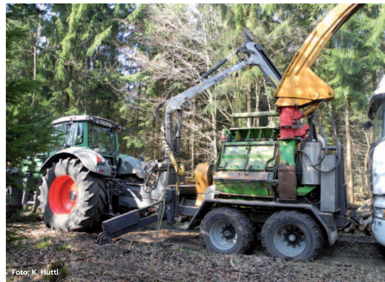
Abbildung 2: Ein Beispiel für eine Maschinenkombination im Antriebsleistungsbereich 200-299 kW ist der Anhängerhacker Heizohack HM 14 800 K an einem Fendt 936 Vario.
