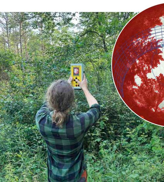
1 links: Lichtmessung mit dem Solariscope; rechts: Hemisphärisches Foto mit Klassifizierung der Vegetationsdeckung anhand von Helligkeitsschwellwerten.
