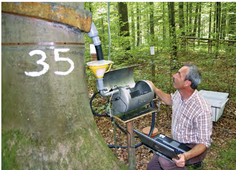
Abbildung 1: An Waldklimastationen werden kontinuierlich und intensiv Umwelteinflüsse und ihre Wirkungen erfasst. Ein Mitarbeiter der LWF bei der Wartung eines Messgeräts zur Bestimmung der an der Rinde einer Buche ablaufenden Wassermenge. Foto: LWF
