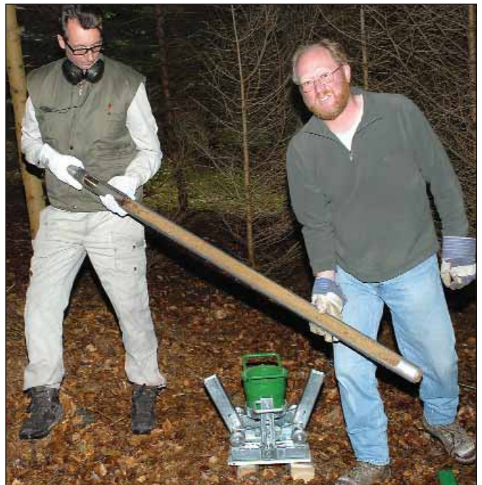
Abb. 3: Nach einigen Mühn ist die Rammkernsonde wieder zu Tage gefördert und dem Bohrkern können die Bodenproben entnommen werden. (Foto: T. Bosch)
