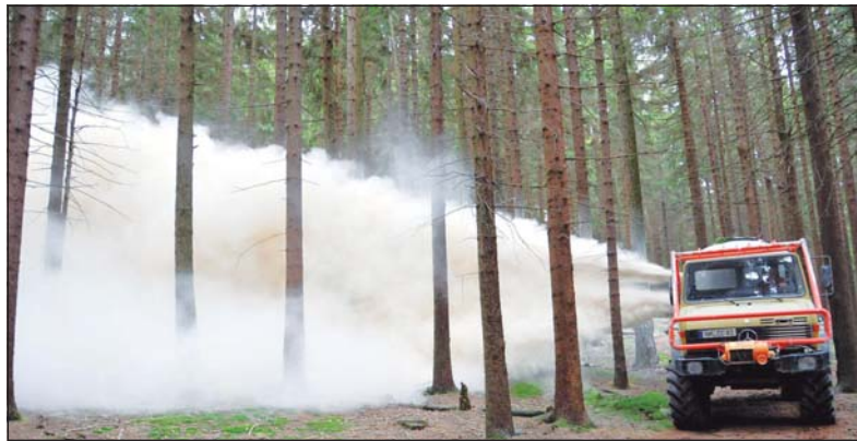
Nahezu punktgenau können moderne Verblasefahrzeuge den Kalk auf der Waldfläche verteilen. Das Bild entstand bei der Kalkungsaktion in der Nähe von Helmbrechts in Oberfranken.
